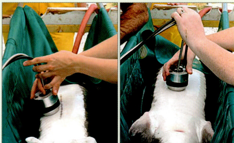
Рис. 2.16. Получение спектров белого осетра с помощью неинвазивного метода коротковолновой спектроскопии в ближней инфракрасной области (Webb et al., 2009)
