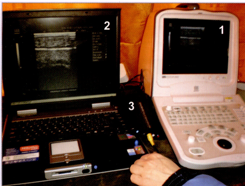
Рис. 1.8. Мобильный информационно-аналитический комплекс на основе УЗИ-сканера Mindray DP-6600: 1 – УЗИ-сканер; 2 – ноутбук; 3 – декодер MPEG2
