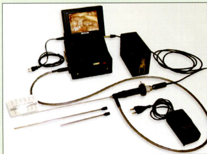
Рис. 2.8. Эндоскопическая система для определения пола и стадий зрелости (на экране изображение яичника на III стадии зрелости)
